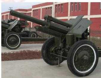
③加农炮是一种初速大、弹道低平、炮管较长的火炮，常用于前敌部队的攻坚战中。
