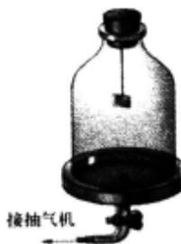
图3-7 探究声音传播的实验装置
