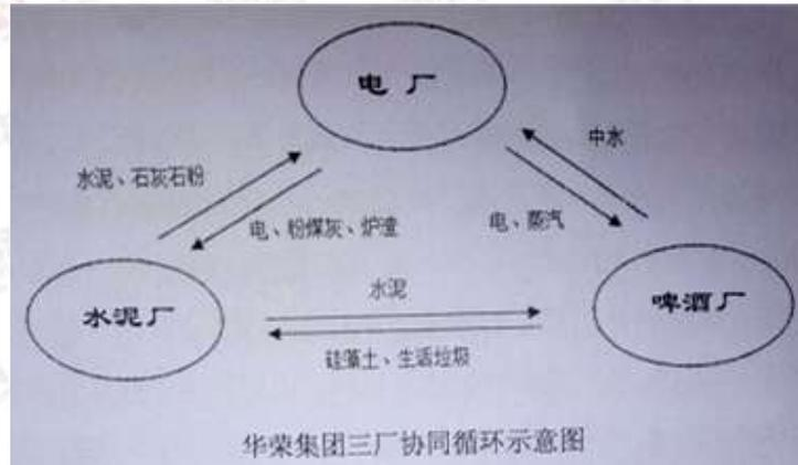
啤酒厂使用电厂提供的蒸汽，节约了另建锅炉房、从水库铺设原水管道、建设污水管网等投资 2000 万元；由于啤酒厂不用单独设立煤场，还节约了至少 30 亩土地；运行上，也没有了锅炉房煤渣处理、烟尘处理，以及原煤消耗、烟尘排放等。啤酒厂每年产生的 80 万吨中水，直接供给电厂作为循环水的补充，节约了水资源。
